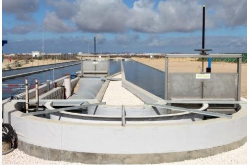
Lagoa raceway convencional (esquerda) vs Low Energy Algae Reactor –LEAR (direita)
